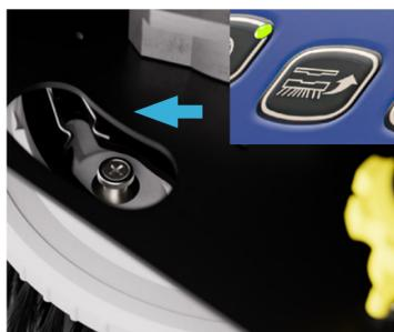
8. Soulevez la brosse et tournez-la vers la gauche pour la verrouiller en position. Si l'option d'encliquetage est disponible, alignez la brosse directement sous le moteur à l'aide du système d'alignement et appuyez sur le bouton d'installation de la brosse. (Version disque uniquement).
