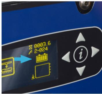
1. Contrôlez l'indicateur de charge de la batterie.
