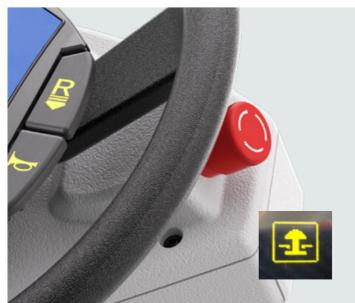
2. L'icône d'arrêt d'urgence s'affiche à l'écran lorsque l'interrupteur d'arrêt d'urgence est engagé. Tournez l'interrupteur d'arrêt d'urgence jusqu'à ce qu'il sorte pour activer la fonction de la machine.
