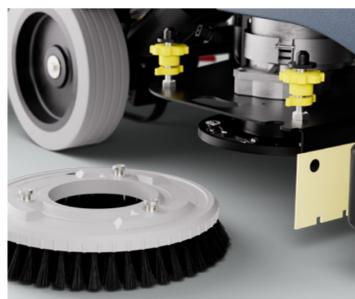
7. Installez manuellement les brosses-disques ou les pilotes de disque. La brosse entre par la gauche.
