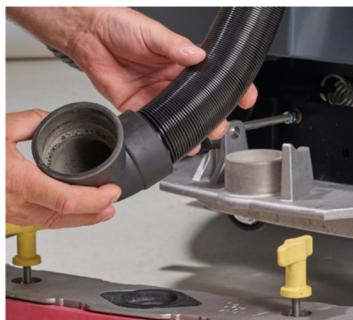
1. Vérifiez que le tuyau d'aspiration est correctement installé et nettoyé.
