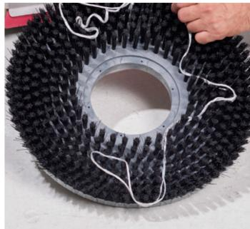
3. Tournez les brosses dans le sens inverse des aiguilles d'une montre et vérifiez s'il y a des matériaux externes et retirez-les.
