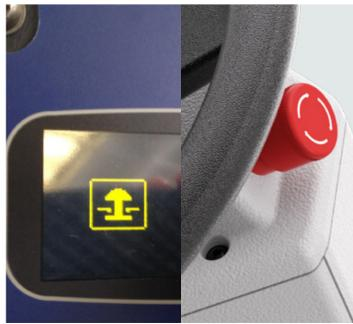
2. L'icône d'arrêt d'urgence s'affiche à l'écran lorsque l'interrupteur d'arrêt d'urgence est engagé. Tournez l'interrupteur d'arrêt d'urgence jusqu'à ce qu'il sorte pour activer la fonction de la machine.
