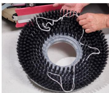
15. Tournez les brosses dans le sens inverse des aiguilles d'une montre et retirez les brosses ou les porte-disques. Rincez les brosses ou les disques à l'eau chaude et suspendez-les pour les sécher.
