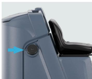
3. Remplissez le réservoir avec de l'eau propre. La température de l'eau propre ne doit pas dépasser 40 °C (104 F).
